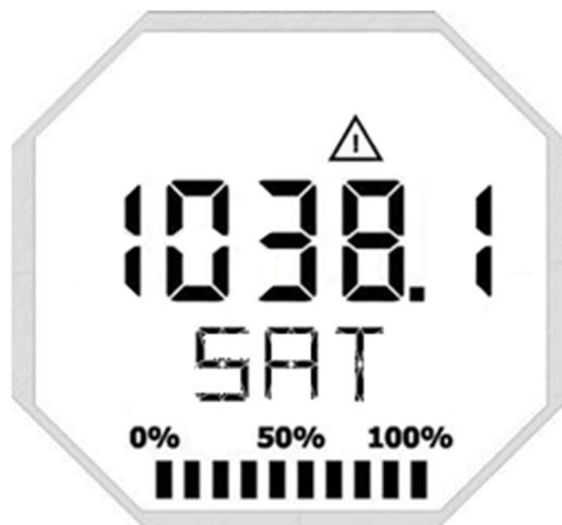
Figura 3.14 – Indicação de saturação da medição.
